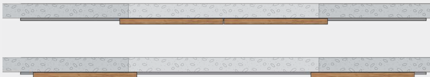
Центральное открывание для двухстворчатых дверей
